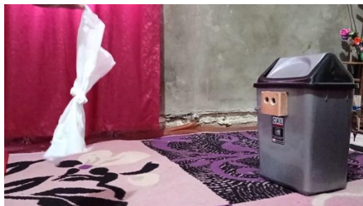
Gambar 9. Pengujian Tempat Sampah Otomatis dengan Tisu
