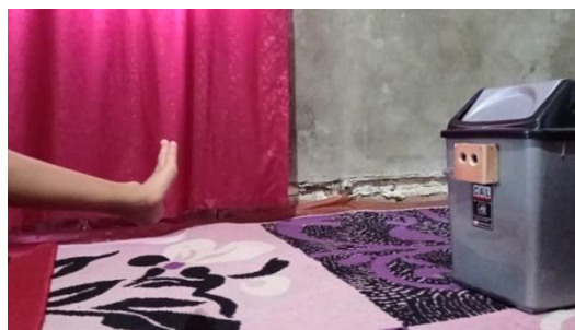
Gambar 3. Pengujian Tempat Sampah Otomatis dengan Kulit/Tangan
